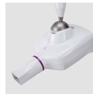
RXDC – tecnología HyperSphere Integrado en el equipo odontológico, el radiográfico y el Pda no necesitan otros puntos de instalación. Óptimo paralelismo gracias a la colimación de 30 cm que, asociado al enfoque de 0,4 mm, garantiza excelentes imágenes. Tocando las zonas touch-sensitive, el cabezal se desbloquea y gira libremente alrededor de la junta esférica.
